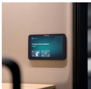
Über ein integriertes UI-Panel können Sie Beleuchtung, Belüftung und den Reservierungsstatus der Kabine steuern.
